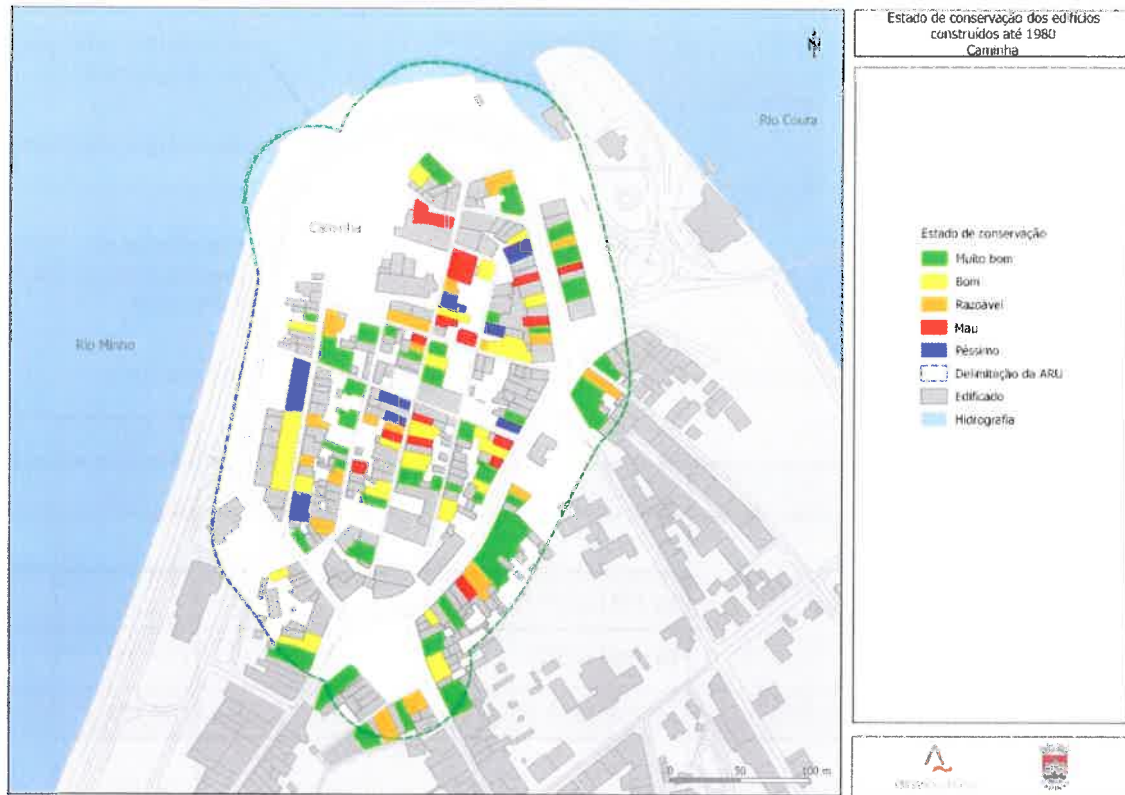
Figura 6. Edifícios com mais de 30 anos com estado de conservação razoável ou pior da ARU do Centro Histórico de Caminha (INE 2011 e CMCB)
